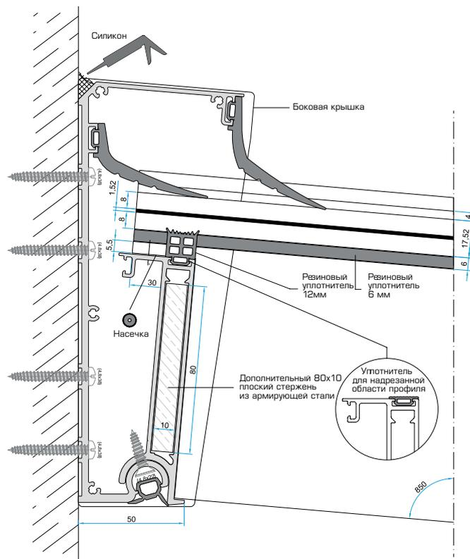
Усовершенствованная система резиновых уплотнителей делает конструкцию абсолютно герметичной.
