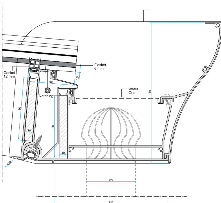
Волнообразный сливной лоток. В него стекает вода с крыши, и затем через колонны сливается на землю.
